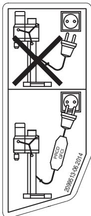
Работать только с исправным автоматом защиты от тока утечки.
