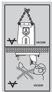
Сверху: горизонтальное бурение с вакуумным креплением разрешается выполнять только при использовании дополнительных устройств крепления станины.
