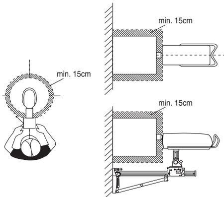
Заштрихованная область обозначает опасную зону установки для бурения. Во время работы держитесь на безопасном расстоянии от буровой коронки — не менее 15 см.
